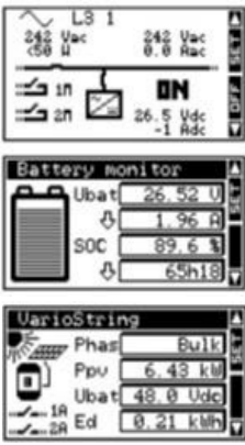
RCC-02の監視画面例
